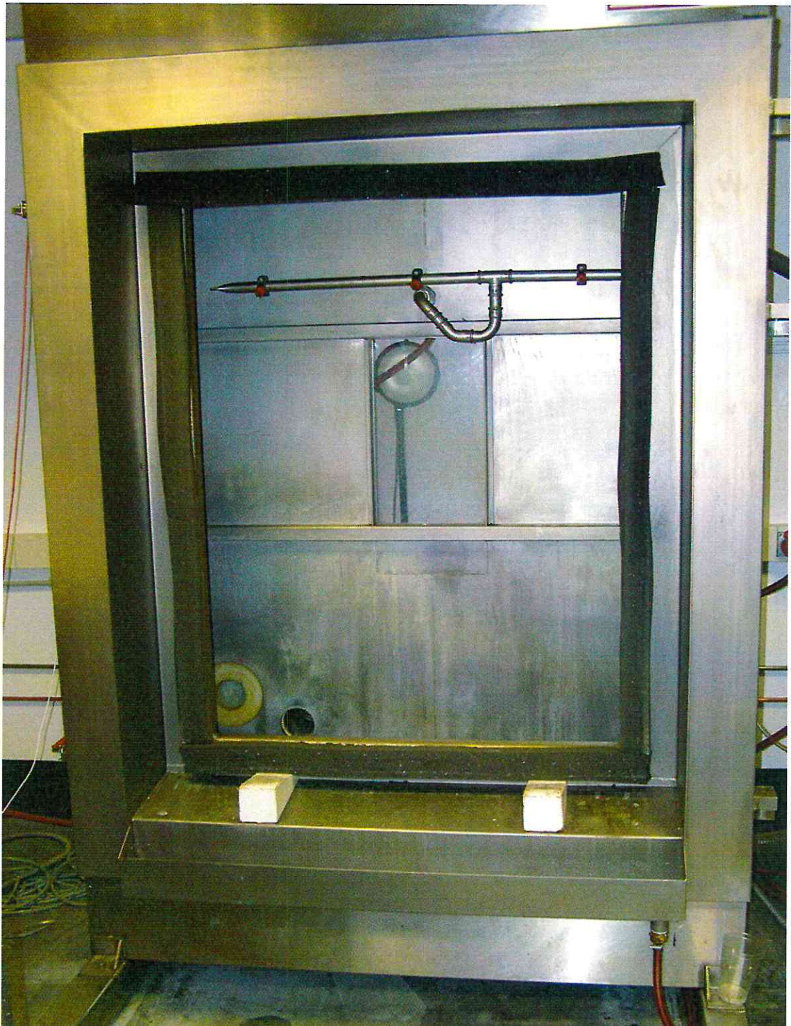
Bild 1: Offener Prüfstand ohne den eingesetzten Versuchskörper
