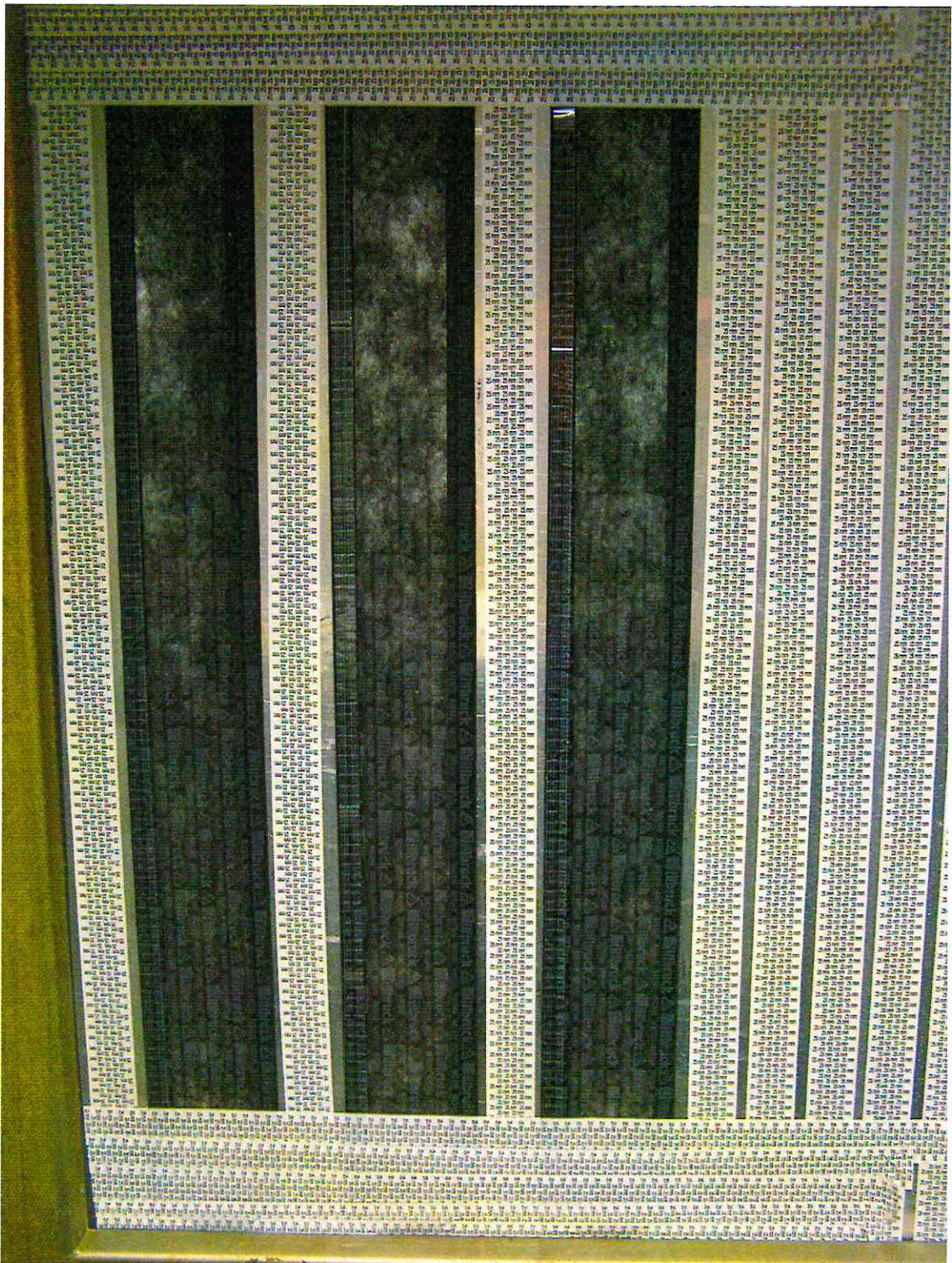
Bild 4: Versuchskörper mit den eingebauten Fugendichtungsfolien (Blick auf schlagregenbeaufschlagte Seite)
